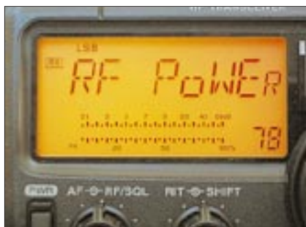
Das unumgängliche Menüsystem gewinnt durch die achtstellige alphanumerische Anzeige an Übersichtlichkeit.
